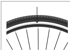
Obr. 2: Kontrolní drážka stavu opotřebení na ráfku.
